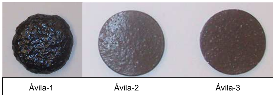
Figura 43 Imagen de las probetas obtenidas tras el ensayo de fusión de las muestras Ávila-1, 2 y 3.
