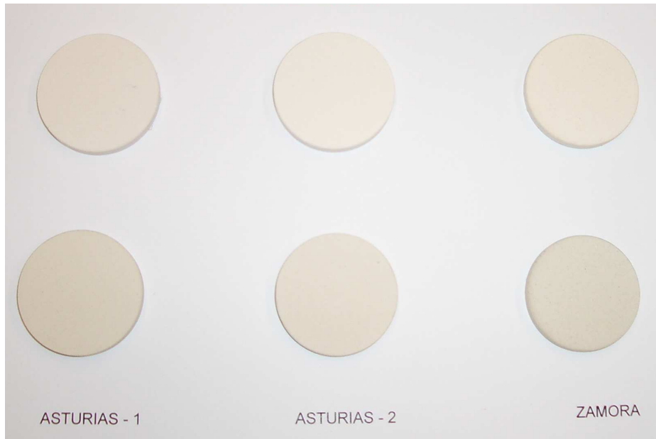
Figura 36 Imagen de las probetas cocidas a 1120°C (fila superior) y a 1220°C (fila inferior) de las arcillas Asturias-1 y 2 y Zamora-1.
