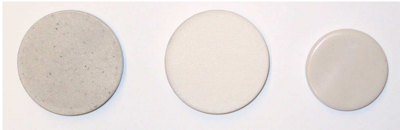
Figura 48 Imagen de las probetas obtenidas tras el ensayo de fusión de la muestra Córdoba-2. Izquierda muestra original, centro muestra sometida a separación magnética con imán permanente, derecha feldespato beneficiado.
