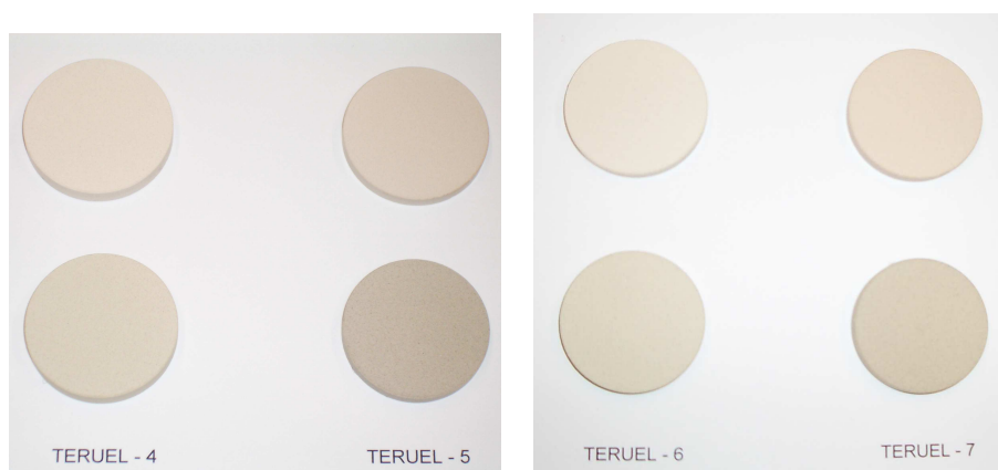
Figura 34 Imagen de las probetas cocidas a 1120°C (fila superior) y a 1220°C (fila inferior) de las arcillas Teruel-4, 5, 6 y 7.
