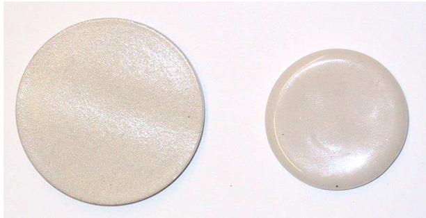
Figura 45 Imagen de las probetas obtenidas tras el ensayo de fusión de la muestra Madrid-1. Izquierda muestra original, derecha feldespato beneficiado.
