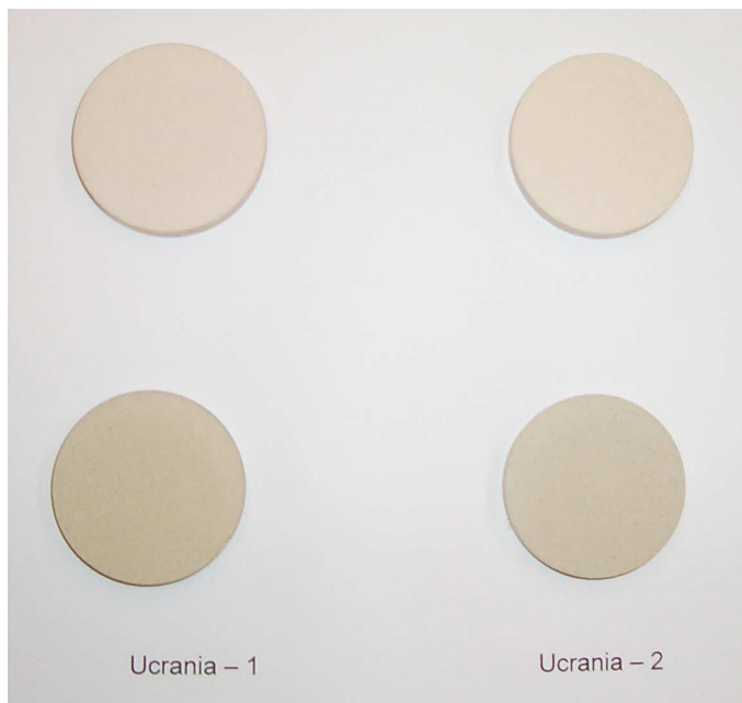
Figura 37 Imagen de las probetas cocidas a 1120°C (fila superior) y a 1220°C (fila inferior) de las arcillas de Ucrania utilizadas en el sector.
