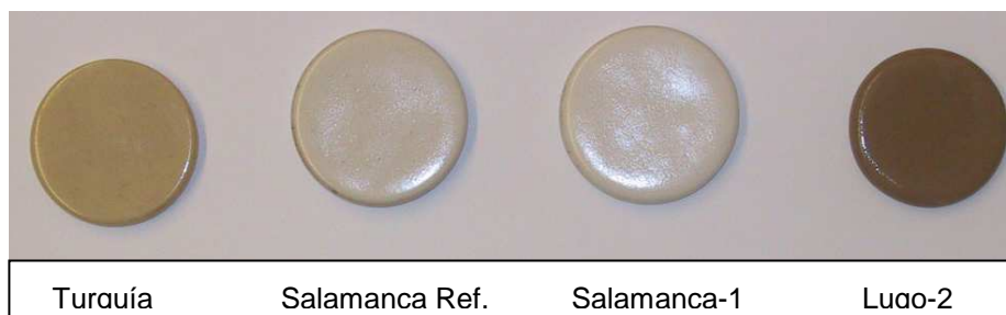
Figura 42 Imagen de las probetas obtenidas tras el ensayo de fusión de feldespatos procedentes de Turquía (calidad media) y de Salamanca y de las muestras Salamanca-1 y Lugo-2.
