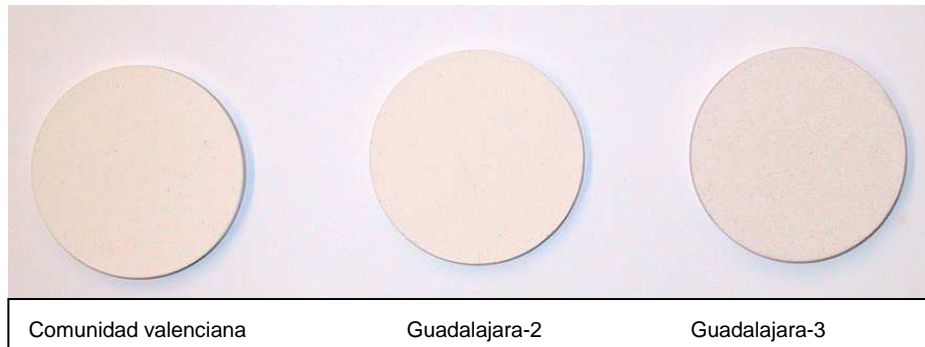
Figura 38 Imagen de las probetas obtenidas tras el ensayo de fusión de una arena feldespática procedente de la comunidad valenciana y de las muestras Guadalajara-2 y 4.
