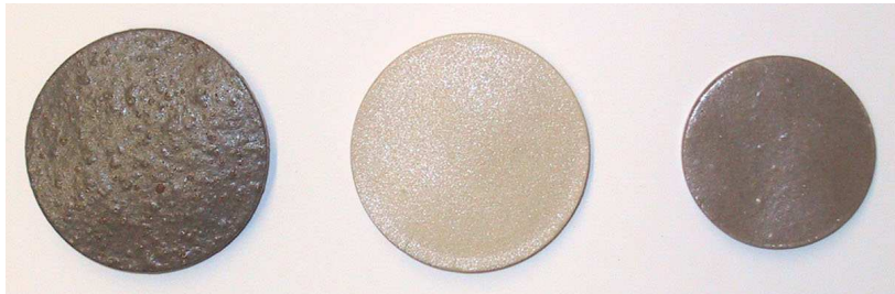
Figura 47 Imagen de las probetas obtenidas tras el ensayo de fusión de la muestra Ávila-3. Izquierda muestra original, centro muestra sometida a separación magnética con imán permanente, derecha feldespato beneficiado.
