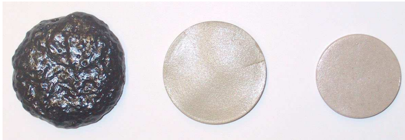
Figura 46 Imagen de las probetas obtenidas tras el ensayo de fusión de la muestra Ávila-1. Izquierda muestra original, centro muestra sometida a separación magnética con imán permanente, derecha feldespato beneficiado.
