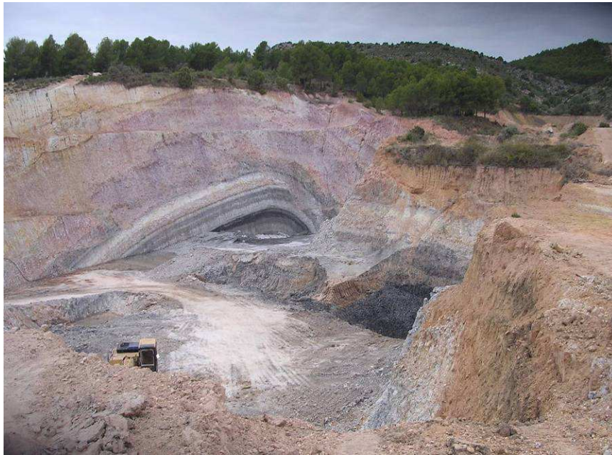
Figura 17.- Presencia de capas de carbón junto a los paquetes de arcillas caoliníferas.
